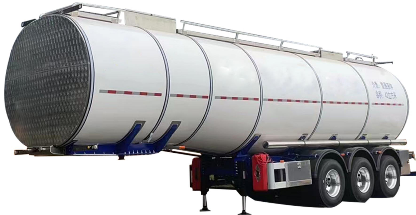
**\*1. Le volume du réservoir est de 42 mètres cubes, avec une embase courte et un poids à vide léger pour le camion-citerne. Les conceptions de charge avant et arrière sont raisonnables, garantissant une conduite en douceur avec un minimum de rebondissements.**
